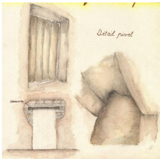
Fig. 50. Porte extérieure sur pivot. Source : dessin étudiants
