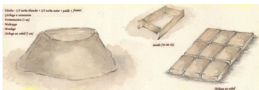
Fig. 38. Préparation de la terre.
